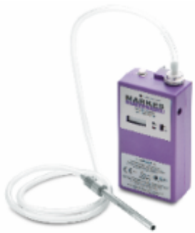
Captación active tubos
