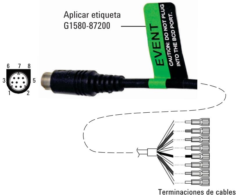
El cable de evento externo tiene dos cierres de contacto pasivos del relé con dos salidas de control de 24 voltios. Los dispositivos conectados a los cierres de contacto pasivos deben conectarse a sus propias fuentes de alimentación.
