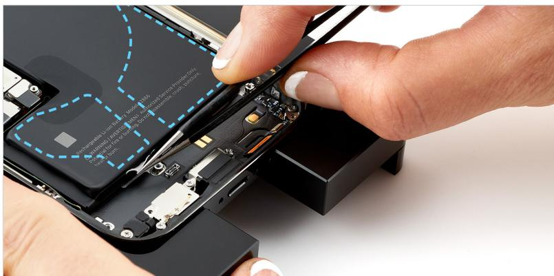
3. Sostén el iPhone. Con unas pinzas antiestáticas, retira la pestaña adhesiva de la batería.
