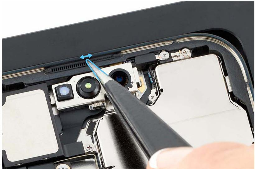
9. Alinea el adhesivo de la pantalla de reemplazo con la carcasa. Comprueba que los agujeros superiores del adhesivo estén alineados con todo el conjunto de la cámara TrueDepth.
