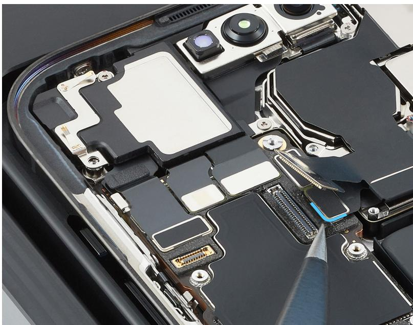
8. Junta los cables flex de la cámara y sujétalos con cuidado mientras levantas la cámara para sacarla de la carcasa.
