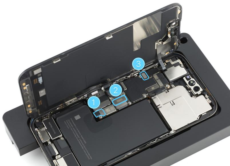
26. Con la barra negra, levanta los extremos del cable flex de la pantalla (2) y el cable del sensor de luz ambiental (3) para sacarlos de los conectores.
