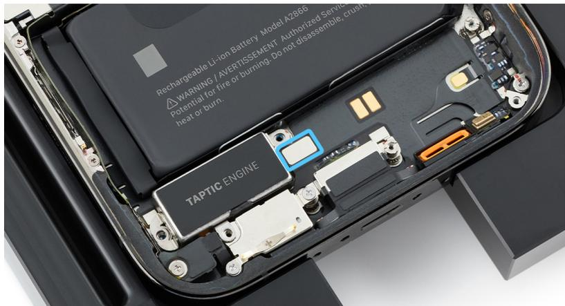
4. Con la llave dinamométrica azul y la punta para tornillos espaciadores, coloca un supertornillo nuevo (923-08151) en el Taptic Engine.
