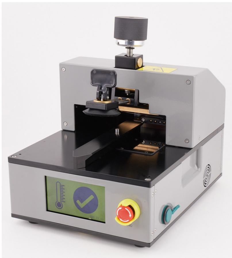
4. Saca el iPhone de la bandeja de reparación. Inserta el iPhone con cuidado en el compartimento de pantalla caliente con la pantalla mirando hacia arriba y el conector Lightning mirando hacia la parte inferior del compartimento.
