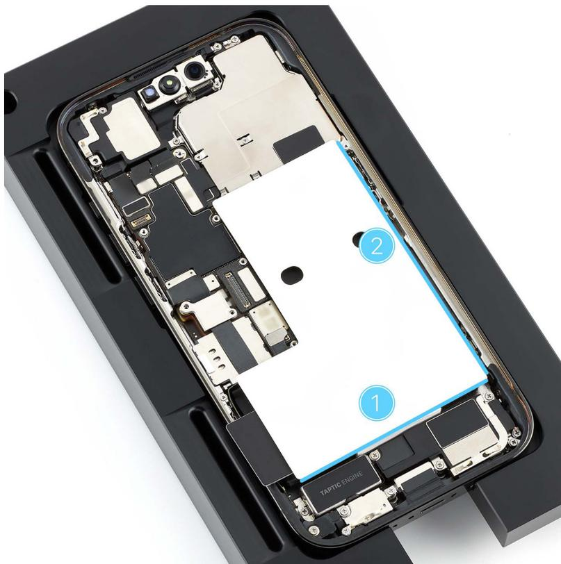
6. El centro de la bandeja de reparación tiene dos ranuras. Coloca la bandeja de reparación y la carcasa sobre la prensa para baterías con la ranura izquierda sobre la clavija como se muestra.
