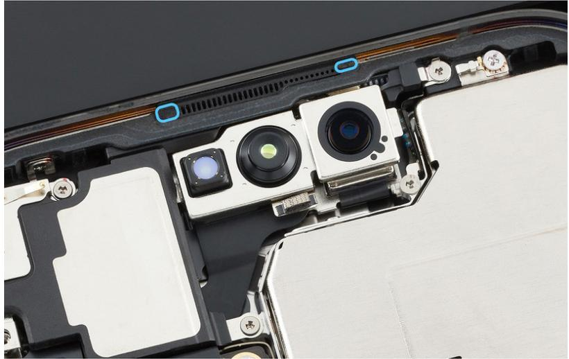
5. Utiliza las pinzas antiestáticas para retirar la rejilla del altavoz superior de la carcasa.
