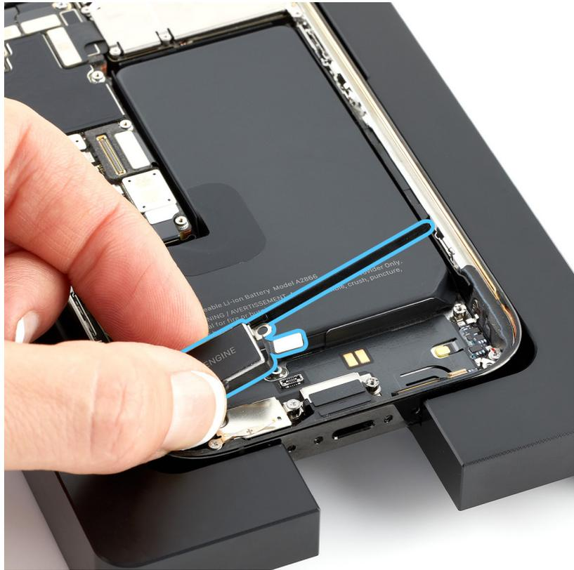
2. Coloca el Taptic Engine y la pieza de asiento de la batería en la carcasa.
