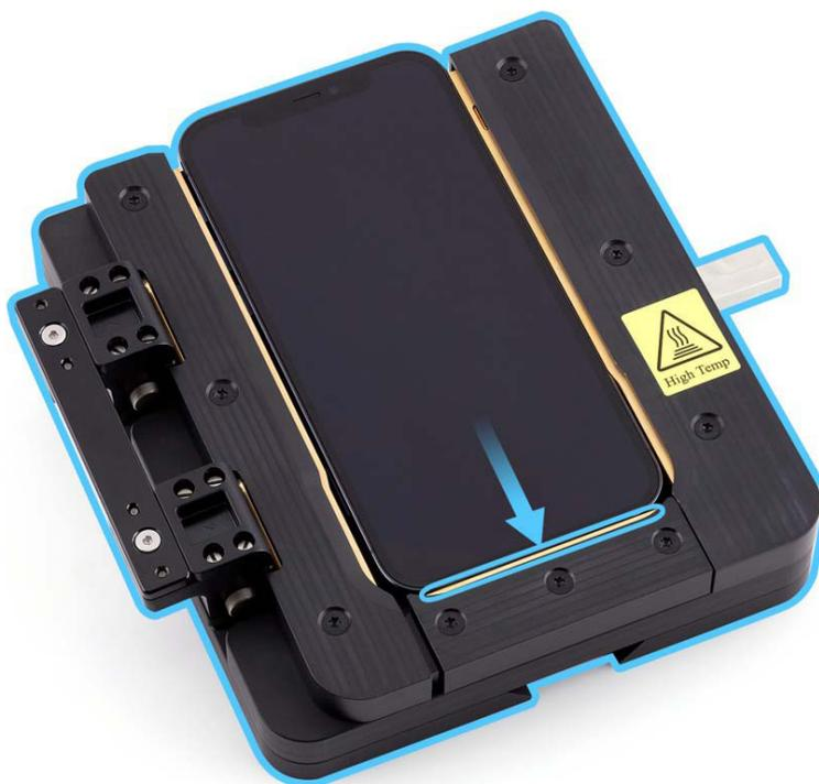
5. Gira hacia abajo la abrazadera del lateral del compartimento para asegurar el iPhone.
