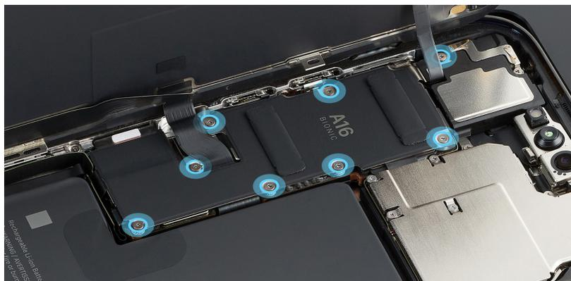
23. Con las pinzas antiestáticas, levanta ligeramente la cubierta de la placa lógica. Asegúrate de que la pestaña inferior de la cubierta de la placa lógica deja libre el cable flex de la pantalla cuando la levantes.
