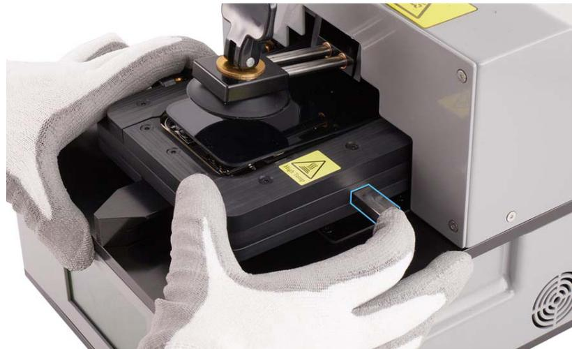
15. Sujeta ambos lados del compartimento y deslízalo para sacarlo del equipo.
