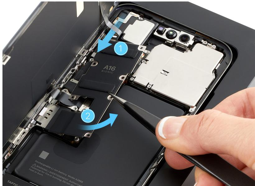
25. Utiliza la barra negra para levantar el extremo del cable flex de la batería (1) y sacarlo del conector.
