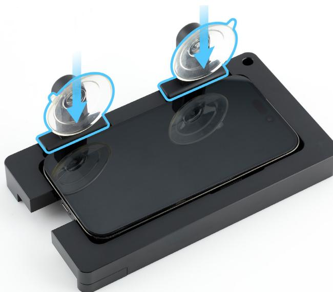
21. Levanta la pantalla hacia las ventosas. Presiona los bordes superior e inferior de la pantalla para fijarla a las ventosas.
