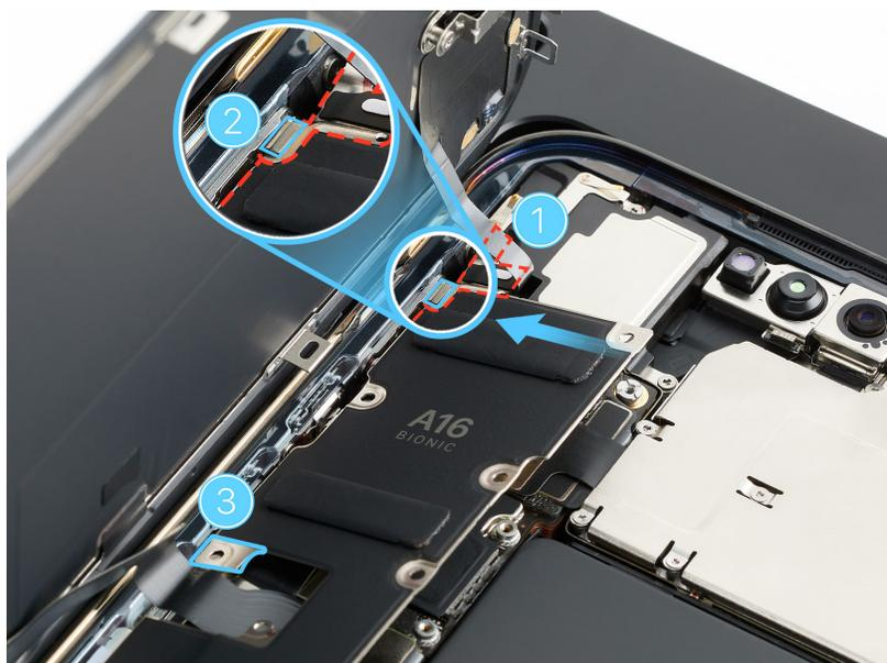
22. Con la llave dinamométrica verde y la punta Microstix, coloca los siguientes ocho tornillos trilobulados nuevos en la placa lógica.
