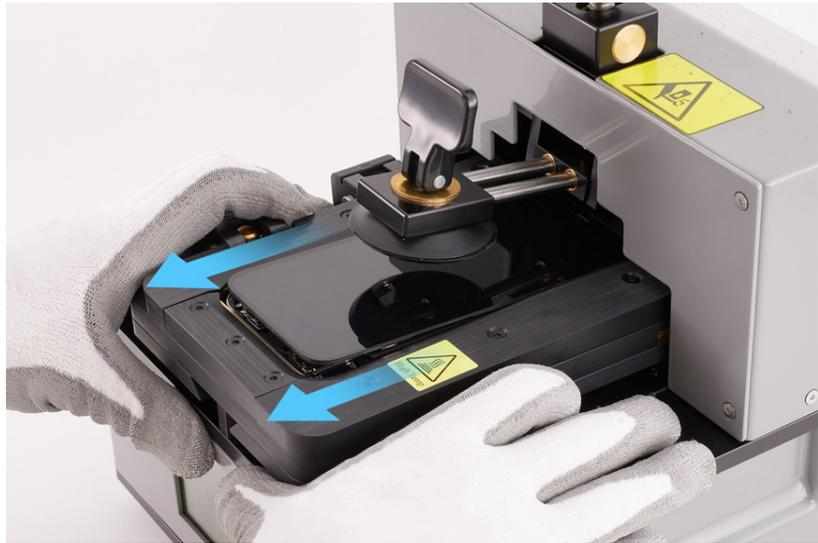
16. Gira hacia arriba la abrazadera del lateral del compartimento para soltar el iPhone (1). Sujeta el área destacada en azul y extrae suavemente el iPhone del compartimento (2).
