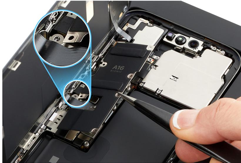
24. Con las pinzas antiestáticas, desliza la cubierta de la placa lógica por debajo del cable flex del sensor de luz ambiental (1). Luego, levanta la cubierta para sacarla de la carcasa (2). Guarda la cubierta para el montaje.
