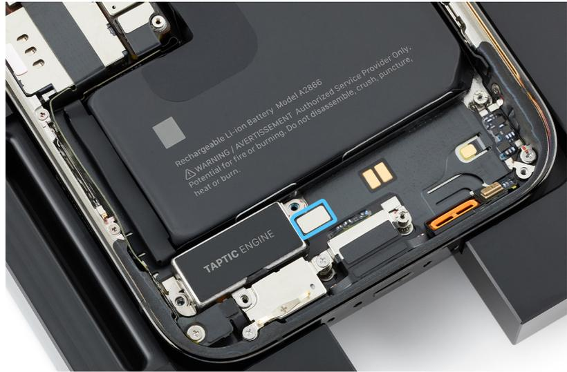
5. Retira el Taptic Engine y la pieza de asiento de la batería de la carcasa.
