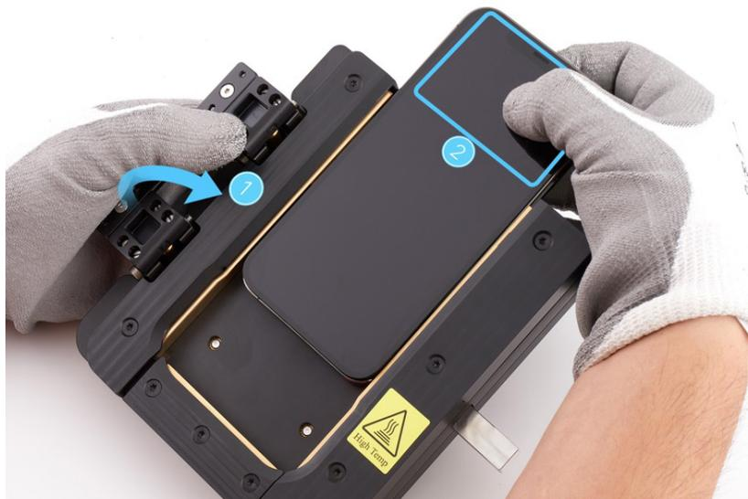
17. Coloca el iPhone en la bandeja de reparación con la pantalla hacia arriba y el conector Lightning mirando hacia el orificio. Quitate los guantes.
