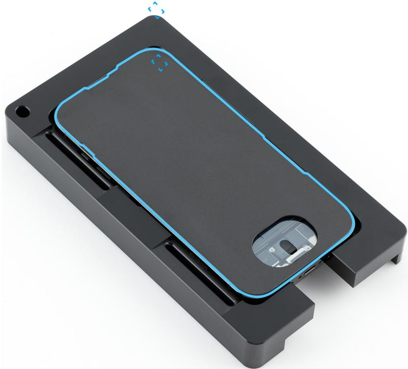
13. Coloca la bandeja de reparación con el iPhone en la prensa para pantallas. Tira de la palanca hacia abajo hasta que se bloquee la prensa para pantallas.
