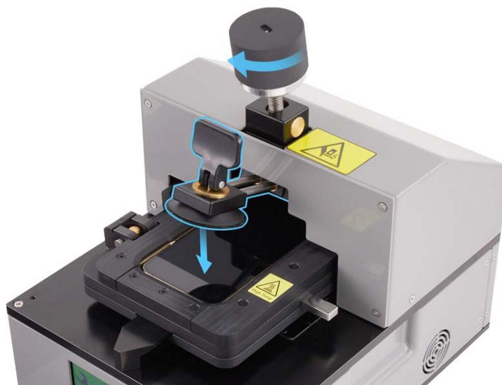
9. Sujeta el mango y desliza la ventosa hacia el exterior hasta que el borde de la ventosa se alinee con el borde inferior de la pantalla.
