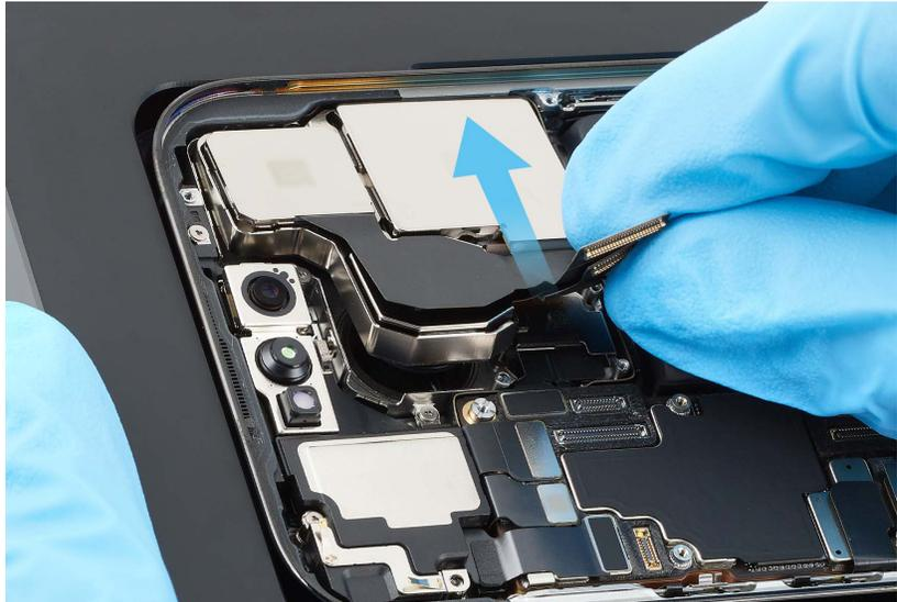
3. Presiona el extremo del cable flex de la cámara inferior contra el conector.
