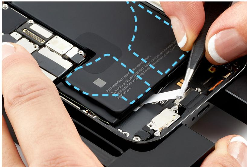
5. Tira de las pinzas hacia el conector Lightning de la parte inferior del iPhone y sigue girando el adhesivo hasta que hayas retirado por completo la tira.
