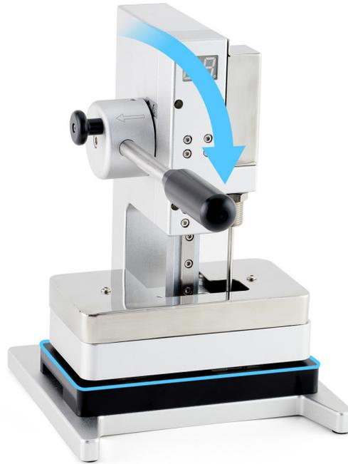
30. Espera hasta que la prensa para pantallas emita un pitido y el temporizador indique 0. Tira de la palanca hacia abajo (1) y tira del botón de desbloqueo (2). Después, levanta la palanca (3).
