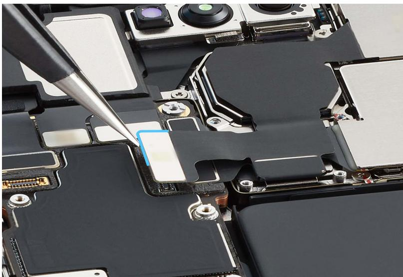
7. Coloca las pinzas antiestáticas debajo de la esquina inferior izquierda del cable flex de la cámara inferior, tal y como se muestra. Después, levanta con cuidado el extremo del cable flex de la cámara inferior para sacarlo del conector.
