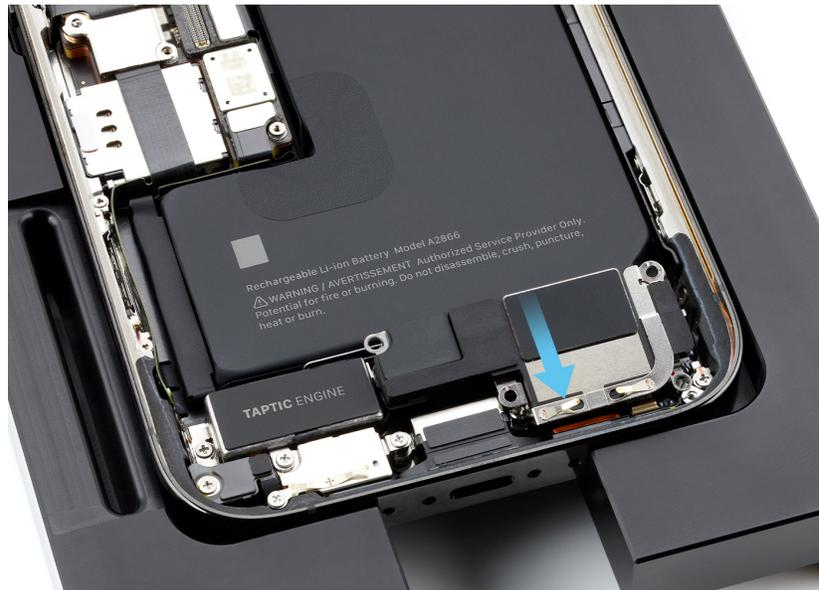
3. Con la llave dinamométrica gris y la punta JCIS, coloca cuatro tornillos de estrella nuevos (923-08147) (1) (923-08377) (2) en el altavoz inferior.
