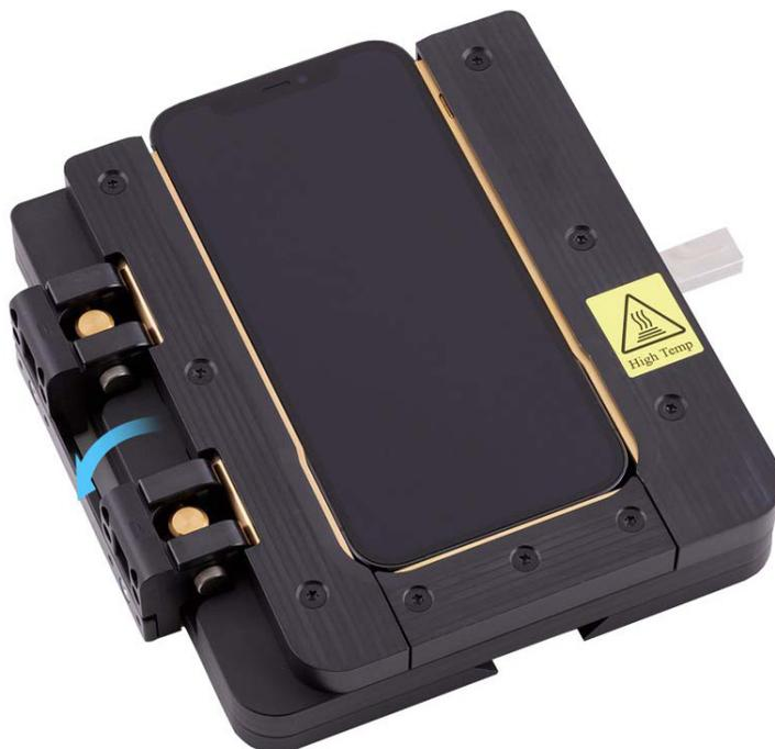
6. Ponte los guantes resistentes al calor. Alinea el orificio de la parte inferior del compartimento con el riel del equipo. Desliza el compartimento con el iPhone por el riel del equipo.
