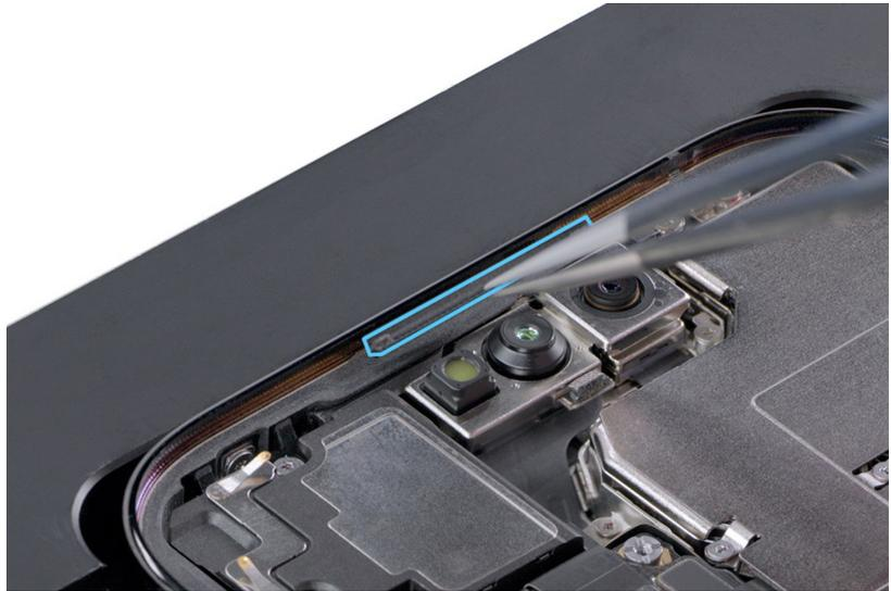
8. Coloca la punta de las pinzas antiestáticas en el centro de la rejilla del altavoz superior. Mueve ligeramente las pinzas de un lado a otro para asegurarte de que la rejilla del altavoz queda firmemente adherida a la carcasa y no se mueve.
