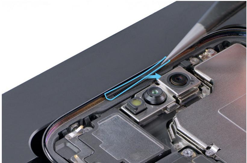
6. Con unas pinzas antiestáticas, despegas el revestimiento adhesivo de la parte posterior de la rejilla del altavoz superior de reemplazo.
