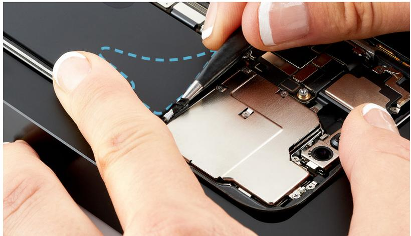
11. Mantén las pinzas cerca del canal entre la batería y la cubierta de la cámara. Sigue girando lentamente las pinzas hasta que extraigas toda la tira adhesiva.
