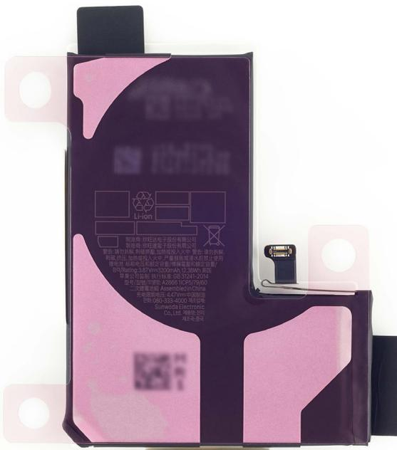
5. Sostén la batería sobre la carcasa con la cubierta protectora hacia arriba. Alinea la parte inferior de la batería con el altavoz inferior (1) y el borde derecho con la carcasa (2). A continuación, inserta la batería en la carcasa.
