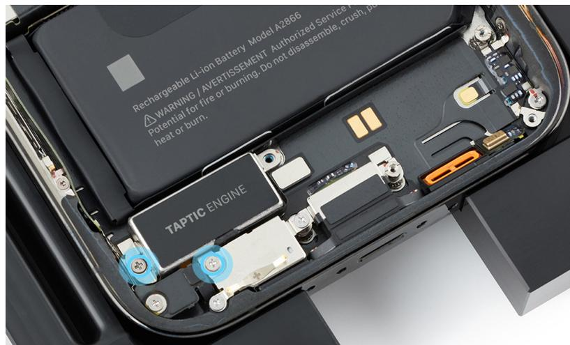
4. Levanta el extremo del cable flex del Taptic Engine para sacarlo del conector.
