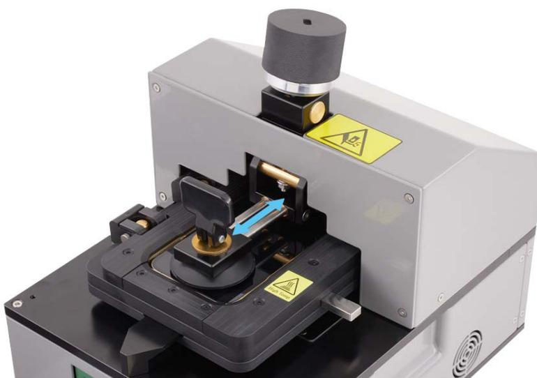
10. Gira el botón del equipo en el sentido de las agujas del reloj para bajar la ventosa hacia la pantalla (1). Después, gira hacia abajo el mango sobre la ventosa para fijar la ventosa a la pantalla (2).
