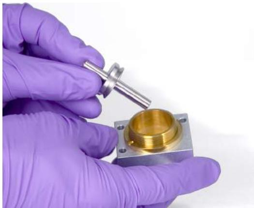
**c** Inserte el otro aislante en la parte superior del colector, con la superficie plana hacia la carcasa.
