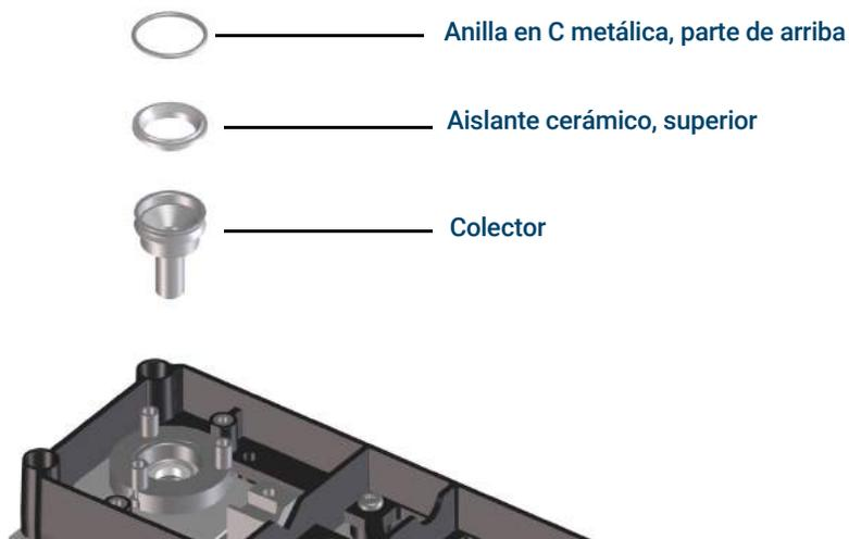
Figura 18. Colector del NPD, aislante superior y anilla metálica en C
