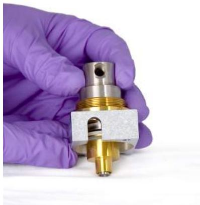
**b** Inserte la tuerca almenada del FID en la carcasa del colector.
