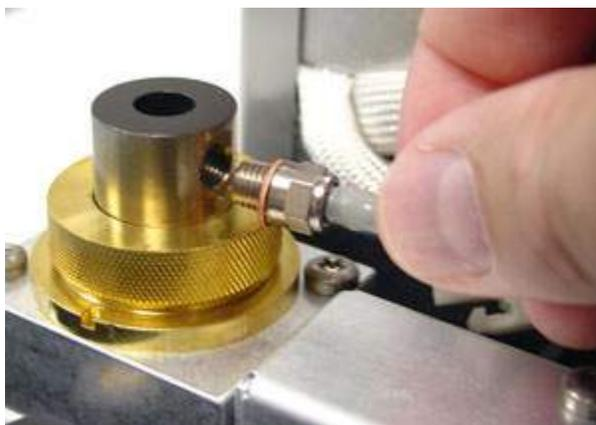
**b** Apriete el encendedor con una llave. Para la ignición se requiere un buen contacto eléctrico, sin suciedad alguna.
