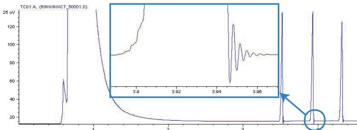
Se ha seleccionado una velocidad de transmisión de datos errónea en el sistema de datos. Para el TCD, la velocidad de transmisión de datos debe ser  $\leq 5$  Hz.
