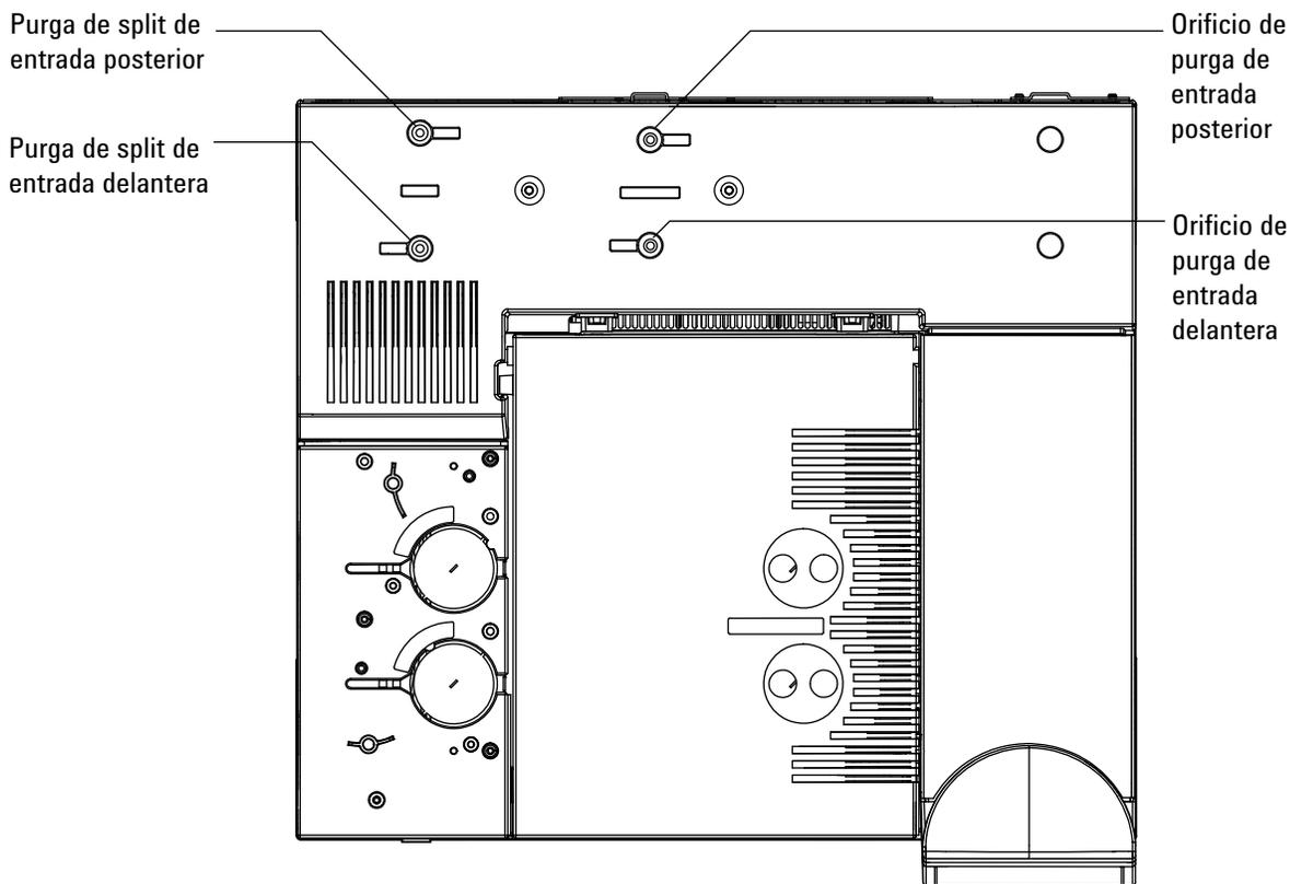
Para medir los flujos de purga de split o de purga de séptum, acople el flujómetro al tubo apropiado. Quite la tapa neumática del GC para obtener acceso a los sistemas de escape del inyector posterior.
