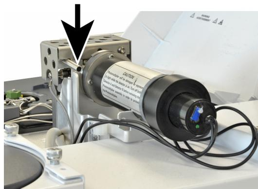
5 Conecte el flujómetro a su adaptador para medir las velocidades de flujo.
