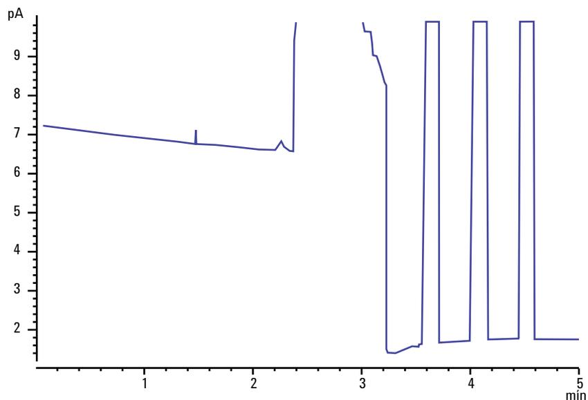
Tras la extinción de la llama, el GC tratará de encenderla tres veces. El GC trata de volver a encenderse cada vez que la salida del detector cae por debajo del valor establecido de **Lit offset** (desviación de encendido), sin importar si la llama se apagó o no (en un sistema muy limpio, la salida de la línea base puede ser menor que 2 pA).
