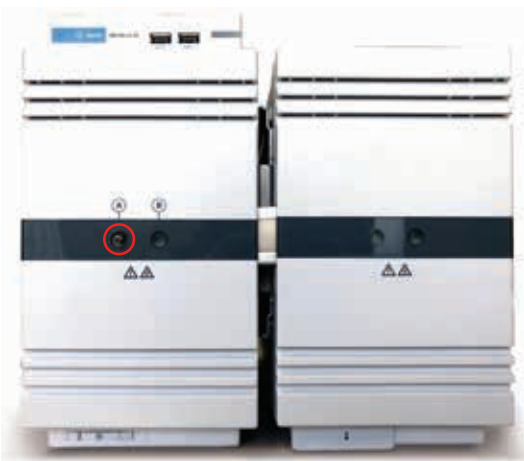
Figura 1B. Analizador NGA de tres canales. El círculo rojo indica la entrada de muestra.
